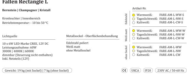
Hinweis: Die Kronleuchter ohne Metallsockel sind nur für die SDK-Decken geeignet. Die Metallseilen ragen direkt aus der Decke aus den kleinen Halterungen heraus. Einbau in eine bestehende SDK-Decke ist nicht möglich, da das Gegenstück an die Deckenbefestigung von der gegenüberliegenden Seite der SDK-Platte geklebt werden muss.
