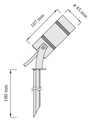
Lichtquelle **Eingangsspannung 24V DC:** 6W LED-Marke CREE 3000K 4000K 6000K dimmbar (Steuerung nicht enthalten)
